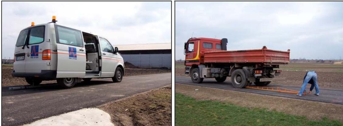
Abbildung 3 und 4: FWD-Messfahrzeug und Benkelmanmessung mit Belastungsfahrzeug
