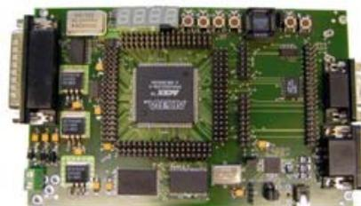
Abb.1: Demoboard mit FPGA
