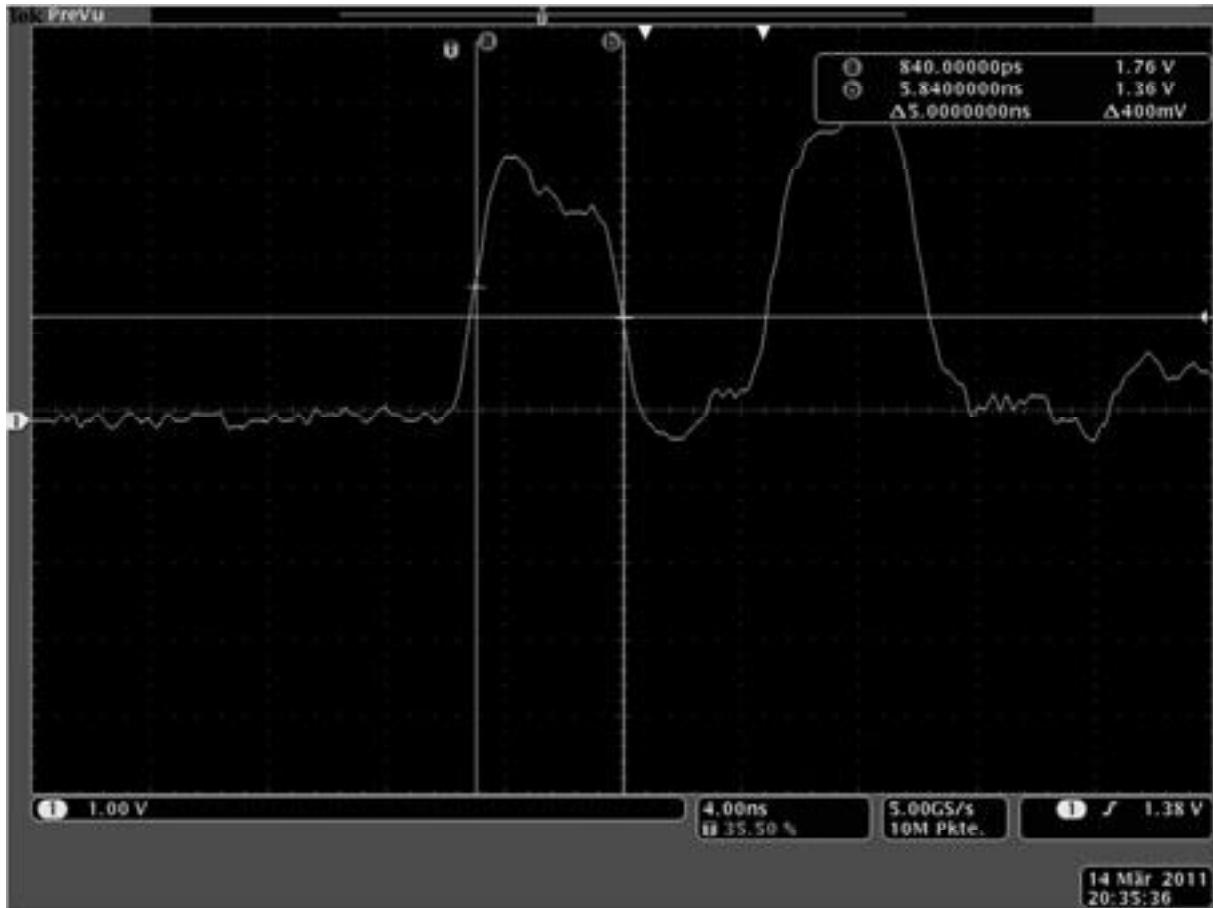
Abbildung 3: MSO Analog – RTE mit 200 MHz Zählertakt - 4 Änderungen mit möglichst kurzem zeitlichen Abstand
