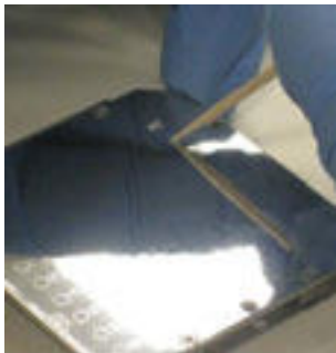
Abb. 2 Probenauftragung bei der MALDI-TOF-MS. Abb. 3 Massenspektrometer Voyager DE PRO
