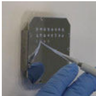
Abb. 2 Probenauftragung bei der MALDI-TOF-MS. Abb. 3 Massenspektrometer Voyager DE PRO
