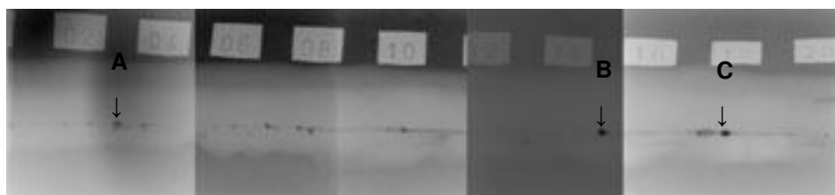
Abb. 6: Montage von Röntgenaufnahmen der Schweißnaht bei 130 kV (zusätzlich zur Schweißnaht wurde ein geeignetes Maßband geröntgt)
