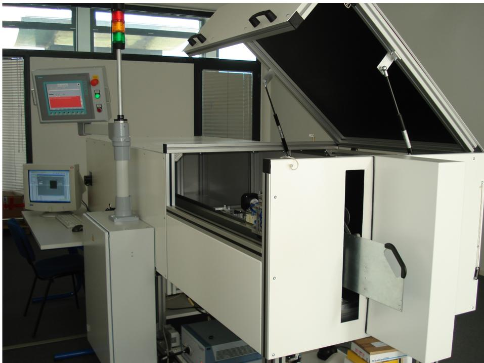
Abbildung 8: Automatisierte LED-Messvorrichtung
